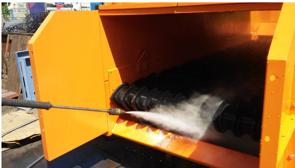
Czyszczenie przestrzeni roboczej sita
