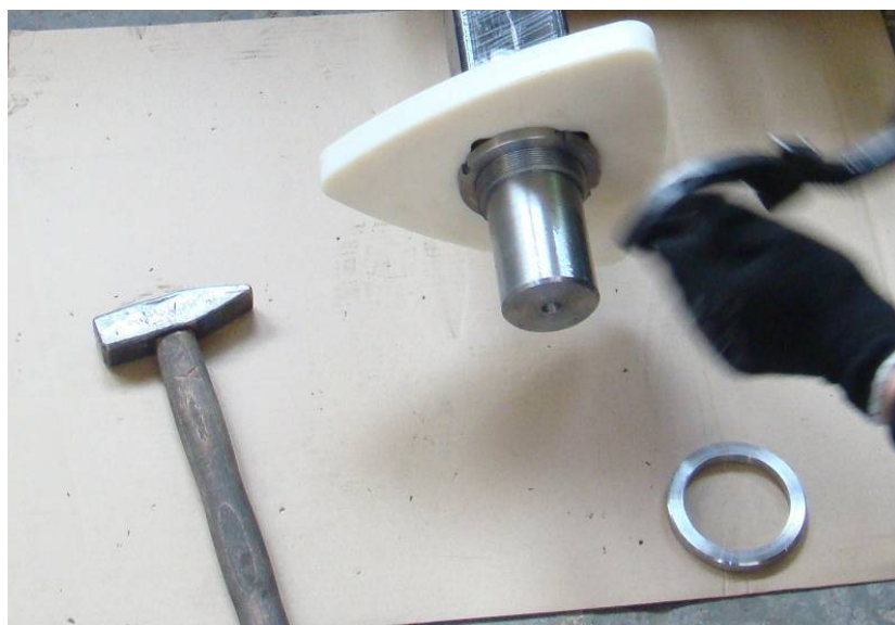
Odkręcenie nakrętki kontrolującej
