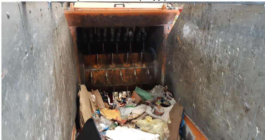
Rysunek 3 Wał rozrywający w rozdrabniaczu.
