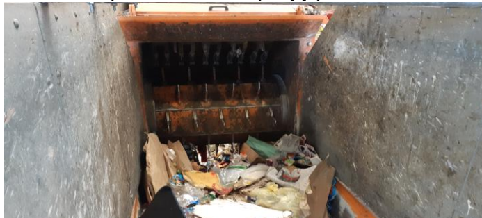
Rysunek 3 Wał rozrywający w rozdrabniaczu.
