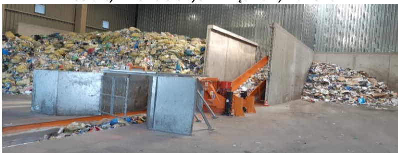
Rysunek 2 Strefa załadunku sortowni odpadów zmieszanych i selektywnie zbieranych w Kędzierzynie Koźlu
