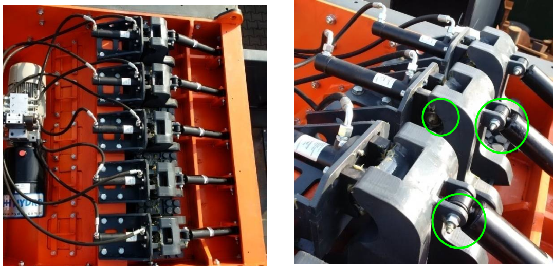
Fig.5. Układ hydrauliczny i punkty smarowania - przykład
